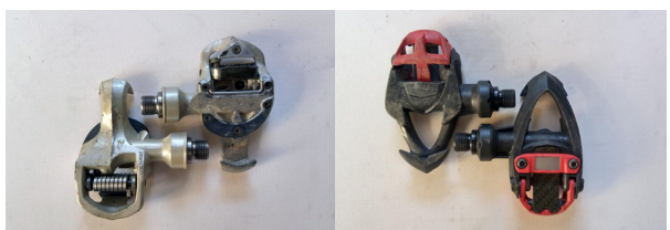
①タイムチタンマグネシウム、チタンシャフトにマグネシウムボディ、これは全体がコンパクトになった二次型、ペアで241g ②その後登場したカーボンボディではスチールシャフトの廉価版でも僅かに軽い234g
