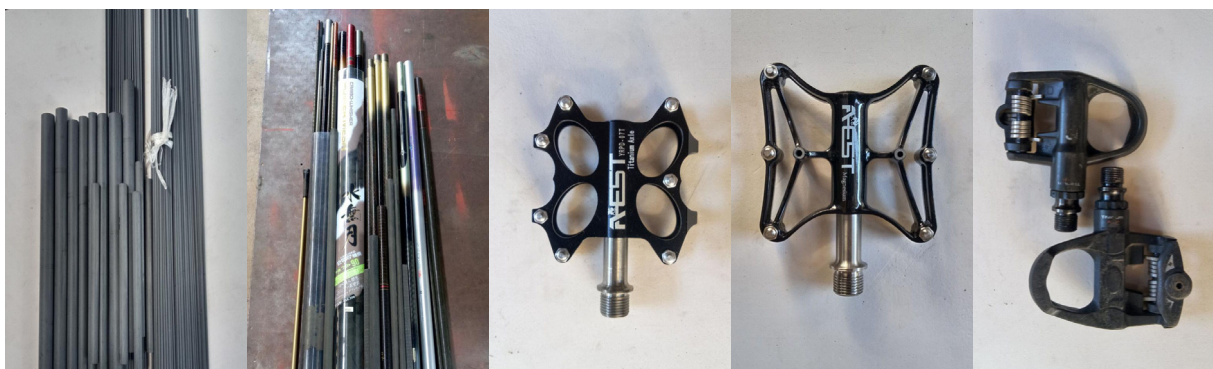
⑦スポーク、ペダルシャフト用など各サイズの棒材。100%カーボンだがこれらは30年以上前の物で現在では低グレードカーボンなのですべて廃棄しなければならない ⑥フレームパイプ用のため未使用の釣り竿とメーカーに注文したストレートやテーパーのカーボンパイプ ⑤アルミボディにチタンシャフト、170g。三輪車レースに使用したのはアルミの方、マグネシウムは転倒時に割れそうな気がする ④マグネシウムボディにチタンシャフトのフラットペダル171g。あまり変わらないがアルミペダルがアルミスパイクピンなのに対しマグネシウムはピンもチタン製のようなだ ③カーボンボディにチタンシャフトは193g
