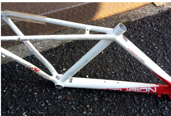
極太のアルミフレーム、これでもロードバイク用。見た目に反し軽い
