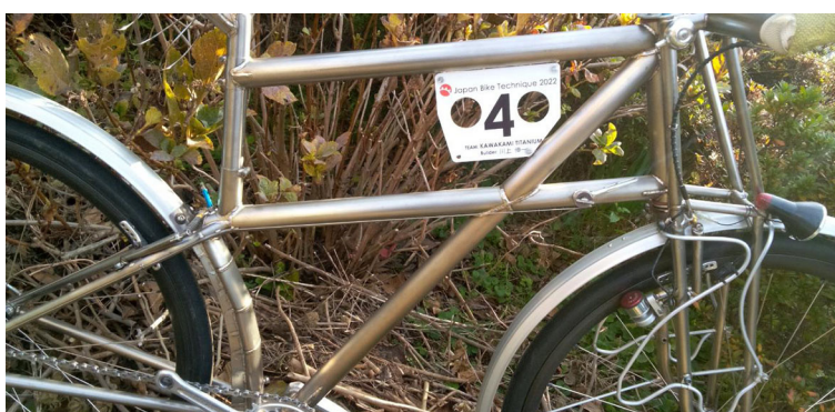
JBT1号車、ヘッドチューブとダウンチューブでは直角に近く衝撃はその先のBBとシートチューブに分散される
