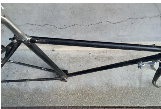
ほぼ全てのパイプが翼断面のクロモリラ付きロードバイク。エアロ効果が高いとカンチブレーキ直付で重量もランドナーフレーム並み
